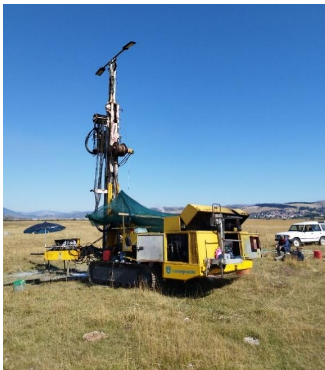
Sl. 4. Garnitura za bušenje Cassagrande C6 na istražnoj lokaciji (Trujić S., 2025)
