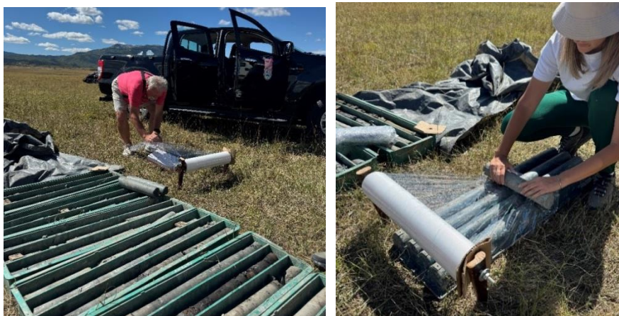
Sl. 8. Uzimanje uzoraka za laboratorijska ispitivanja fiziko-mehaničkih svojstava stenskih masa (S. Trujić, 2025)
