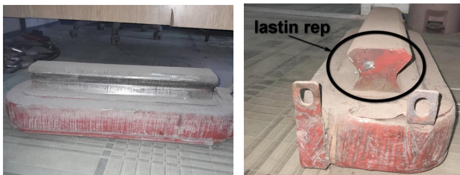
Sl. 7. Pol sinhronog generatora ЦГД 89/38-8
