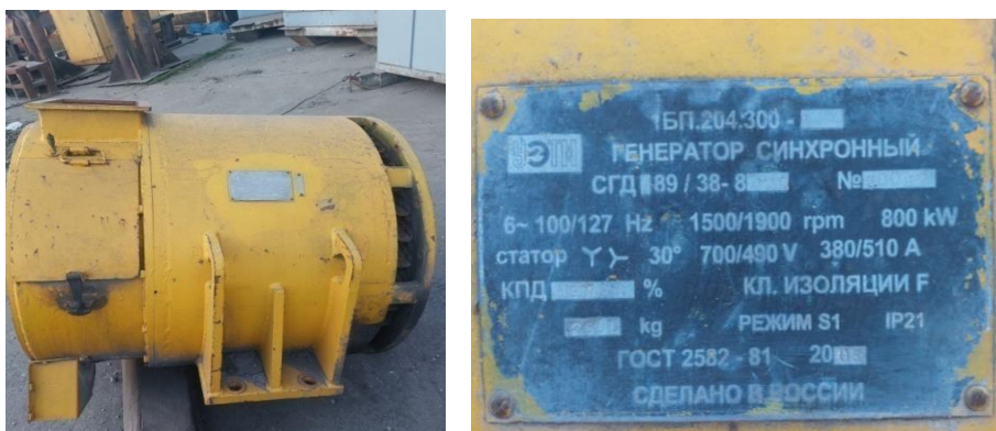
Sl. 6. Sinhroni generator СГД 89/38-8 i tablica sa tehničkim podacima
