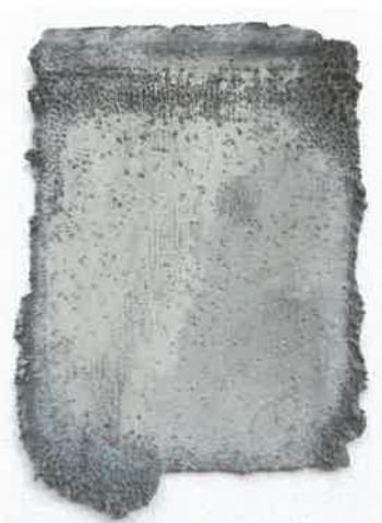
Slika 6. Makrofotografija katodnog depozita Zn (ispitivanja na uvećanom laboratorijskom nivou)
