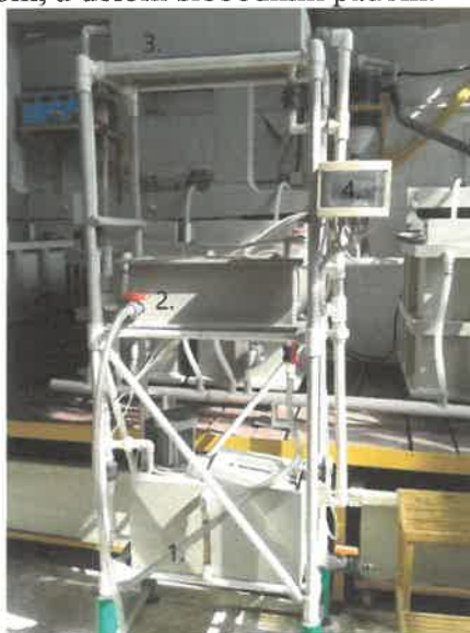
Slika 5. Uvećano laboratorijsko postrojenje za elektrolitičko izdvajanje Zn iz elektrolita dobijenog luženjem filterske prašine
