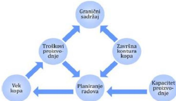
Slika 1. Kružni tok optimizacije proizvodnje na površinskom kopu (Sevim i Lei, 1998)
