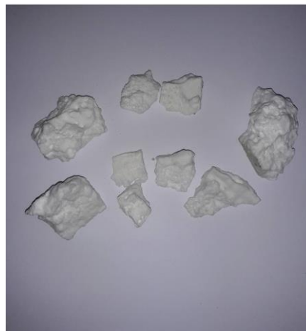
Slika 2. Kalijum pirofosfat u kristalnom obliku pre usitnjavanja dobijen u Institutu za rudarstvo i metalurgiju u Boru
