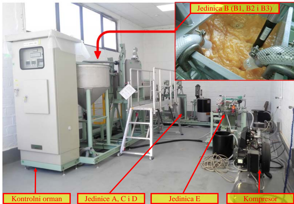
Slika 3. Pilot postrojenje za dvostepenu neutralizaciju.
