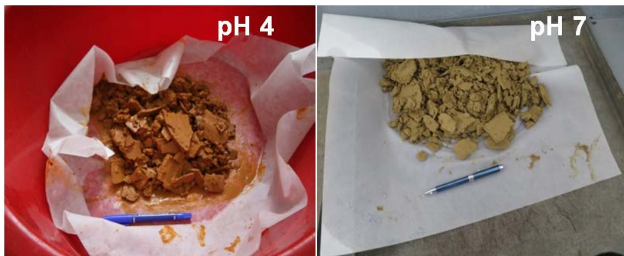
Slika 7. Selektivni muljevi iz postupka dvostepene neutralizacije
