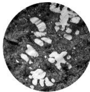
b) Legura L3: Sn70In21Ag9 uvećanje 125x
