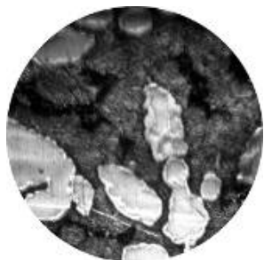
a) Legura L1: Sn50In35Ag15 uvećanje 200x
