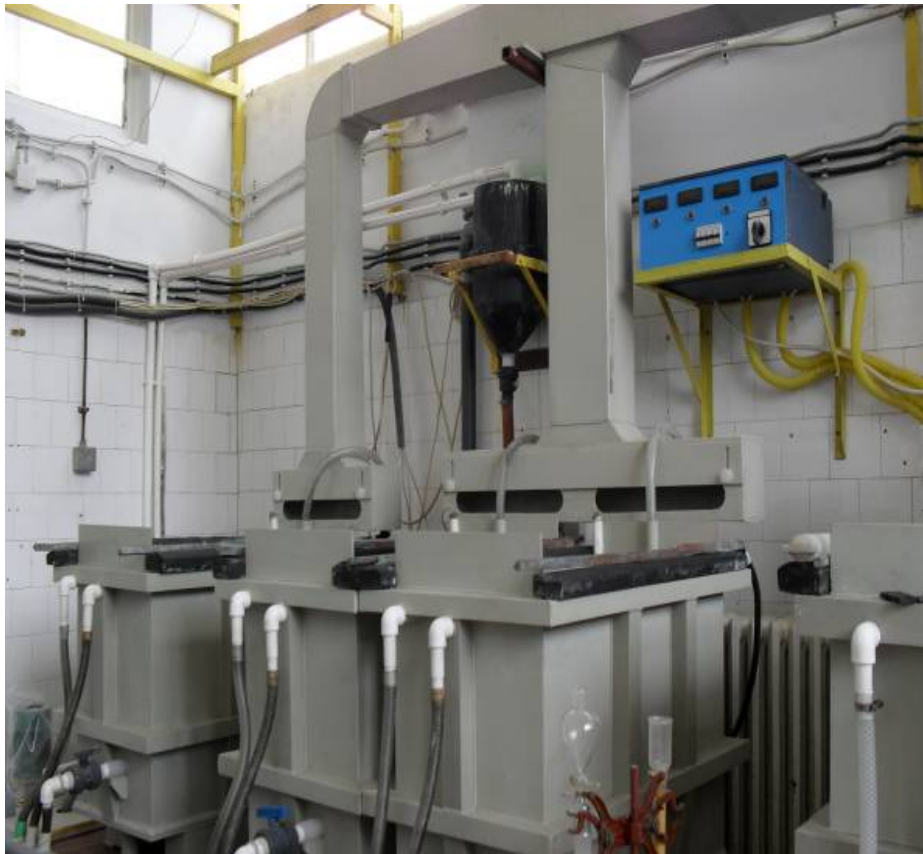
Slika 1. Novo poluindustrijsko postrojenje za elektrolitičku preradu bakarnih anoda nestandardnog hemijskog sastava – Linija I
