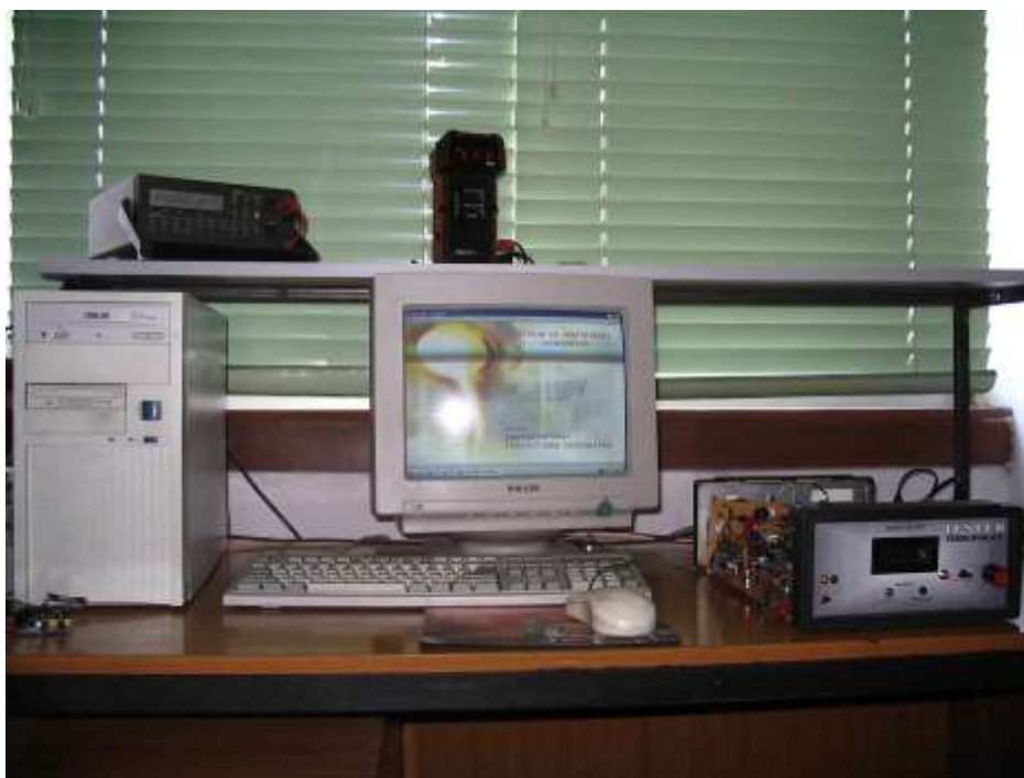
Slika 2. Kontrolni deo sistema: PC računar, MMS sa interfejsom i instrumenti
