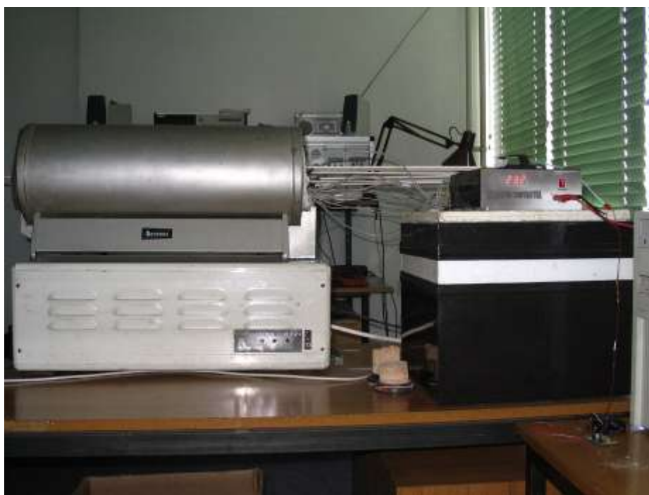
Slika 3. Kontrolisani deo sistema: žarna peć, kompenzator i termoparovi
