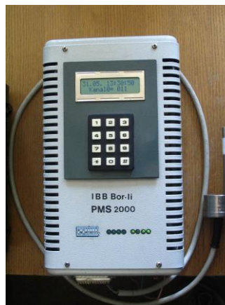
Slika 11. PMS - raspored modula i izgled kompletnog uređaja
