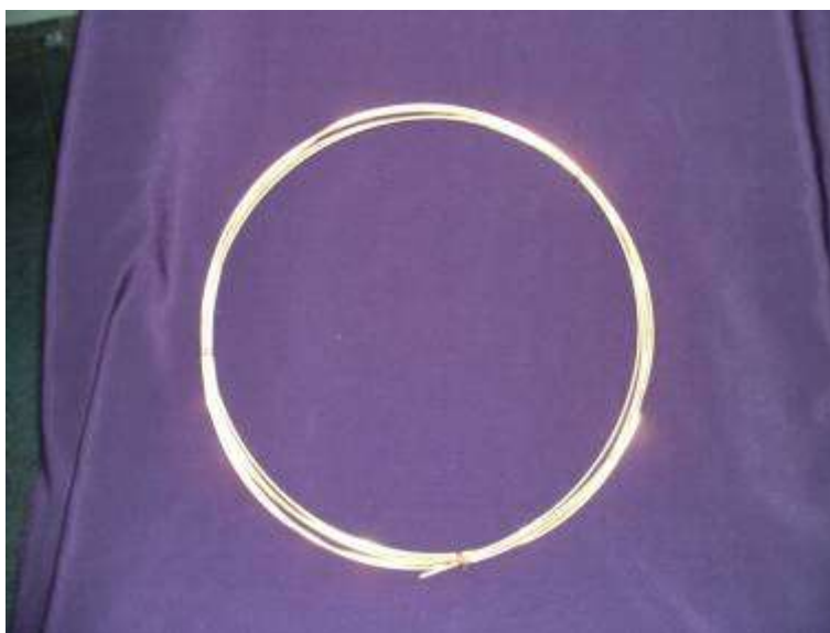
Slika 5. Dobijeni CuZnSnSiMn lem u obliku žice
