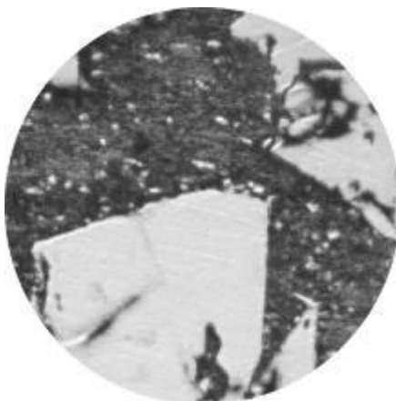
Slika 2. Mikrostruktura legure L2: Sn75In17,5Ag5Cu2,5
