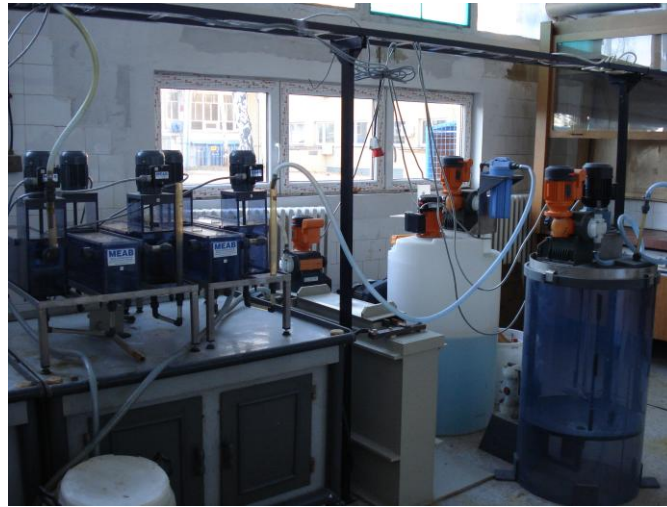
Слика 4. Увећано лабораторијско постројење за SX-EW процес
