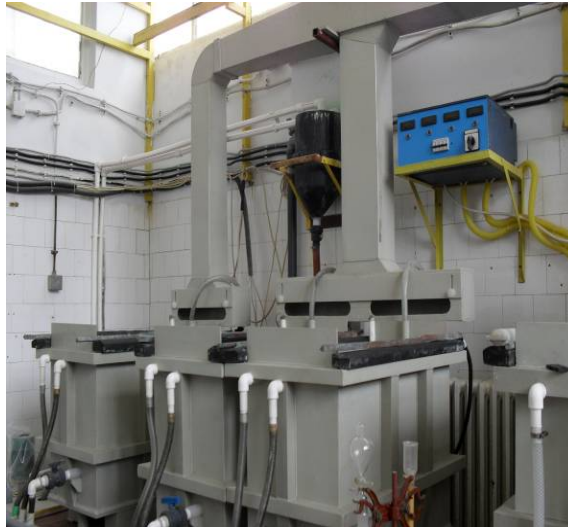
Slika 1. Novo poluindustrijsko postrojenje za elektrolitičku preradu bakarnih anoda nestandardnog hemijskog sastava – Linija I
