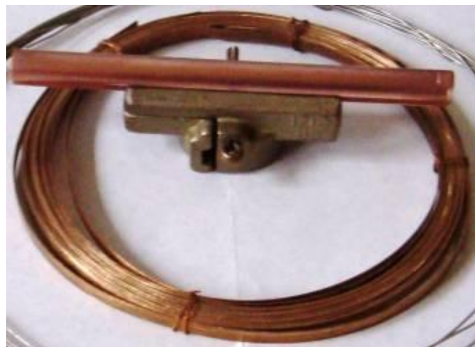
Sl.12. Dobijeni različiti profili shape memory CuZnAl materijala
