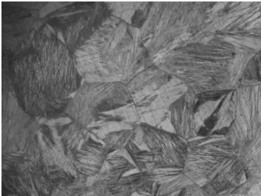
Sl.11. Mikrostruktura uzdužnog preseka CuZnAl legure termički tretiran na 800 °C, a zatim okaljene u vodi (uvećanje 80:1)
