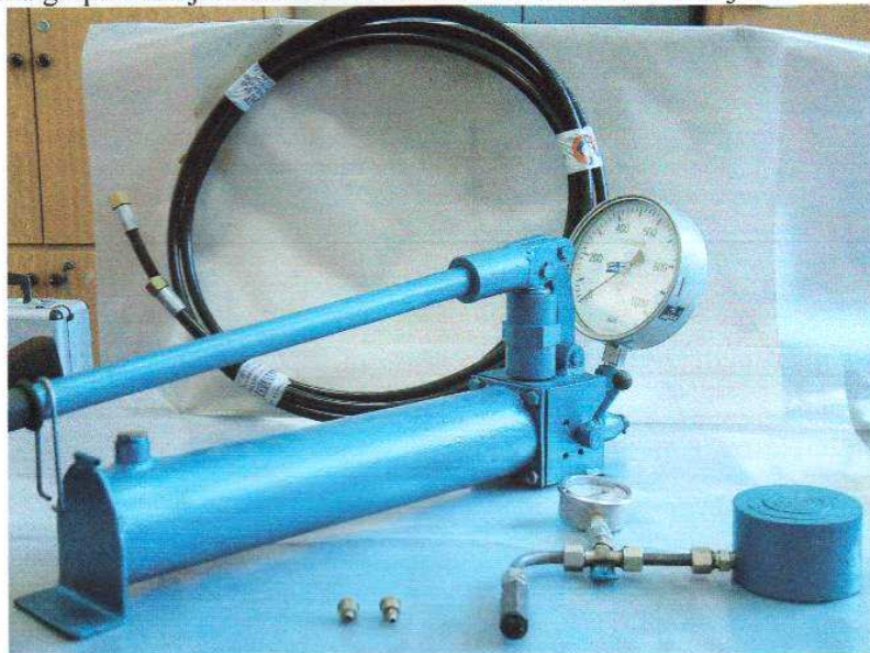
Slika 2. - Merna sonda sa dodatnim alatima za merenje naponskih stanja
