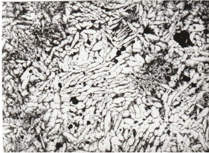
Slika 5. Mikrostruktura livene CuAl9Ni4Fe4Mn2 legure
