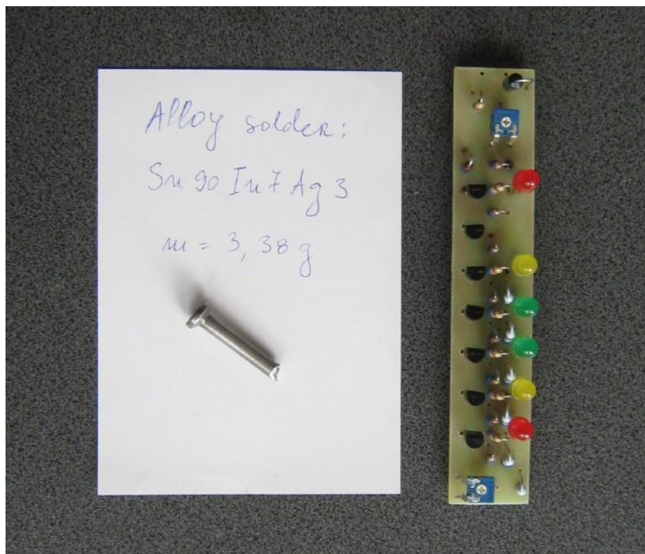
Slika 3. Vrh ploče štampanog kola sa uzorkom novog materijala Ag_3In_7Sn_{90}
