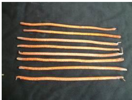
Slika 2. Predprofil od dvoslojne žice za dalju plastičnu preradu
