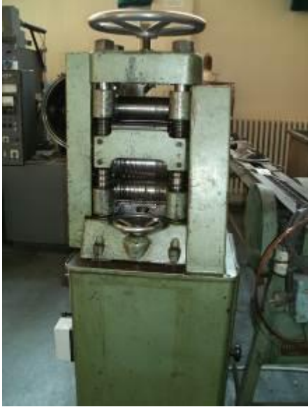
Slika 3. Oprema za plastičnu preradu valjanjem i za termičku obradu
