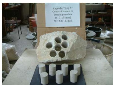
Sl. 2. Pripremljeni uzorci za ispitivanje od osnovnog kamena
