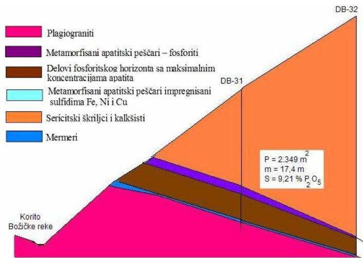
Sl. 2. Karakterističan poprečni profil, (br. VII), kroz ležište fosforita „Lisina“
