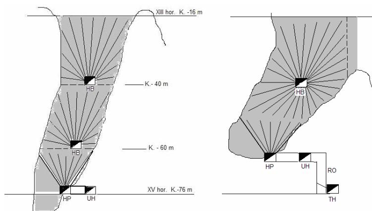
**Sl. 8. Predlog metode podetažnog okopavanja u otvorenim otkopima raspoređenim po pružanju pojedinih delova rudnog tela**
