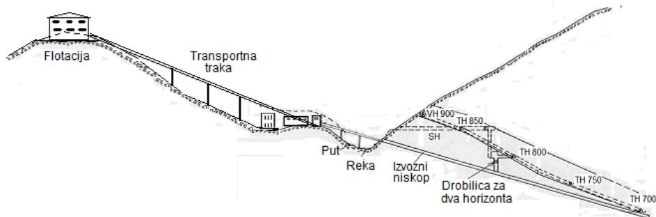
Sl. 5. Predloženi način otvaranja ležišta fosforita Lisina
