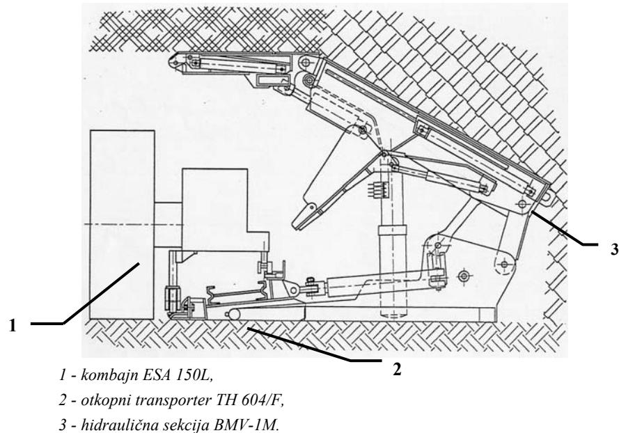
**Sl. 1. Shematski prikaz mehanizovanog širokog čela**
