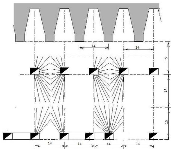
**Sl. 6. Predlog II varijante metode otkopavanja sa otvorenim otkopima kod koje su podetažni hodnici za bušenje u bokovima otkopnog bloka**
