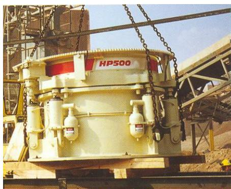
**Figure 5.** Tertiary crusher „Nordberg“ HP Series Cone Crushers, HP 500, „metso-minerals“
