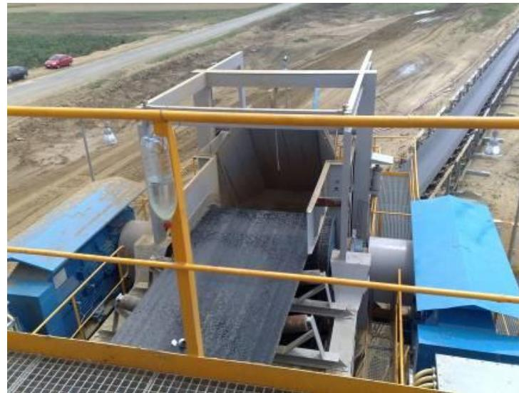
**Sl. 2.** Presipni levak i dva reduktora sregnuti sa pogonskim bubenjem
