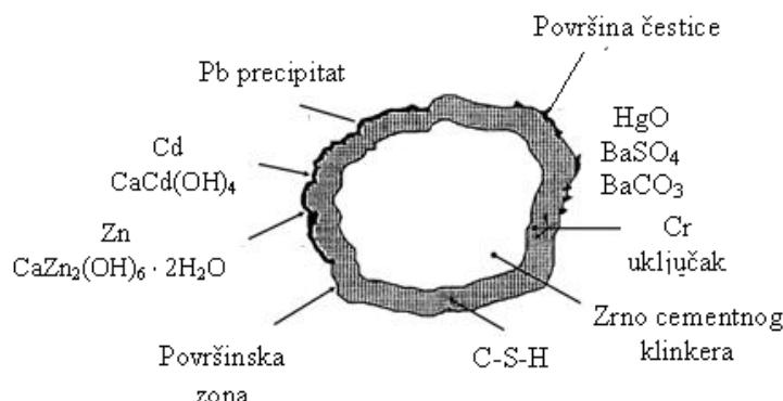
**Sl. 1. Proizvod procesa stabilizacije i solidifikacije opasnog otpada sa sadržajem teških metala, primenom Portland cementa kao aditiva [6]**
