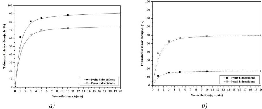
Sl. 2. Kinetika flotiranja bakra iz preliva i peska hidrociklona:
