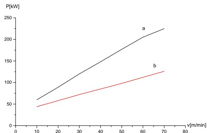
Sl. 5. Snage iz ispravljača u funkciji proizvodne brzine (a-TDK fer. imp., b-FA imped.)
