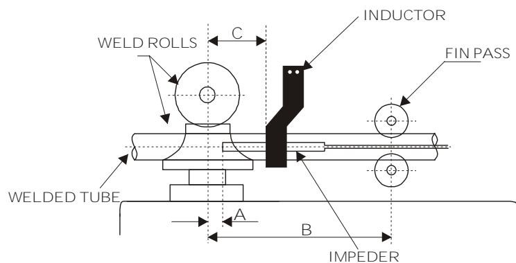
Sl. 1. Detalj uređaja za VF induktivno zavarivanje
