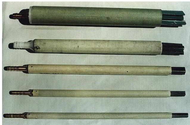
Sl. 3. Epoksidne čaure sa novim impederom od magnetodielektrika
