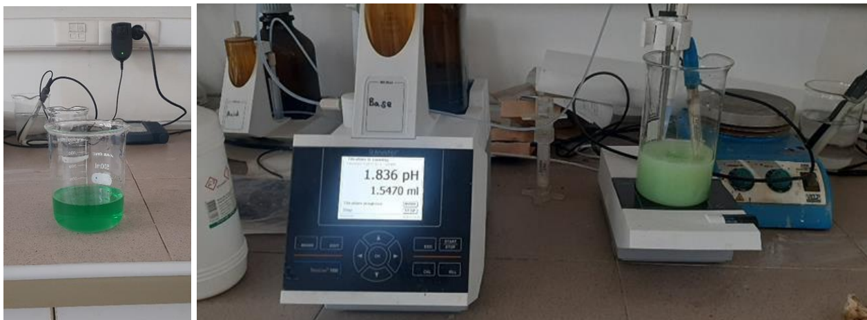
Слика 10.3.1.1. Неутрализација рафината са 1 М NaOH
