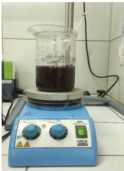
Слика 10.5.3.4.1. Лабораторијски експеримент процеса лужења на повишеној температури
