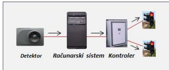
Sl. 1. Šematski prikaz hardverske strukture adaptivnog sistema upravljanja saobraćajem
