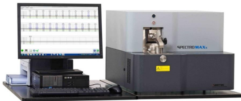
Sl. 2. SPECTRO MAXx LMX06, optički emisijski spektrometar [14]
