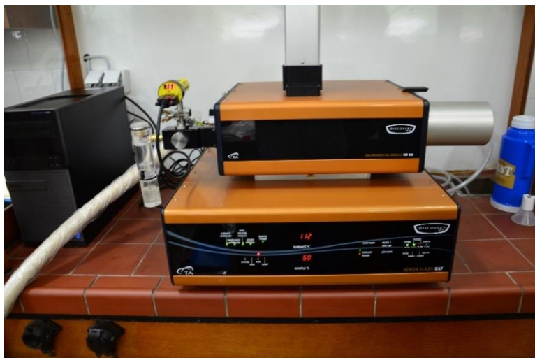
Sl. 3. Uređaj za merenje toplotne difuzivnosti - Discovery Xenon Flash, DXF-500, TA Instruments [15]
