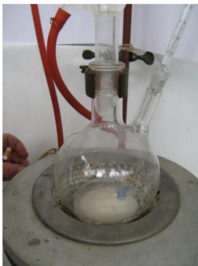
Sl. 1. Balon sa rektifikacionom kolonom za sintezu merkaptotriazola
