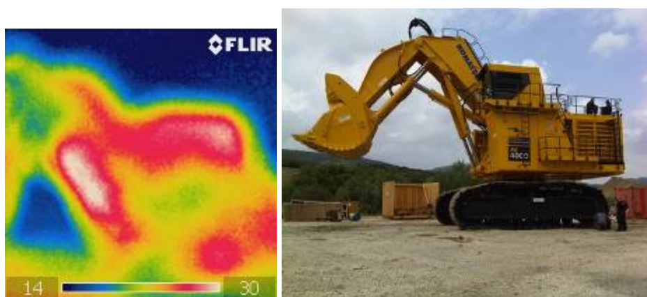
Slika 3. Termovizijski snimak i standardna fotografija bagera Komatsu PC 4000
