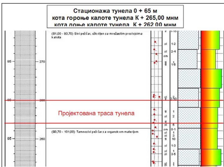
Sl. 2. Izgled profila bušotine kroz koji se vidi projektovana trasa tunela
