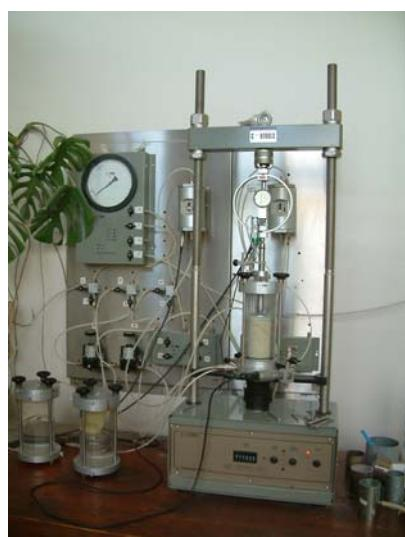
Sl. 2. Izgled triaksijalnog aparata za tlo sa pratećom opremom
