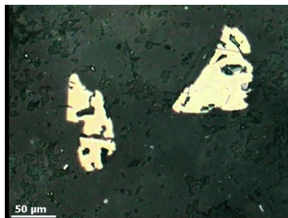
Sl. 2. Agregati halkopirita (žuto) uklopljeni u silikatnoj podlozi (tamnosivo). Vazduh, II N.
