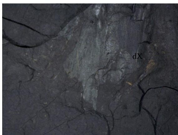
Sl. 4. Detro-ksilit (dX), binocular, uvećanje 6,5 x
