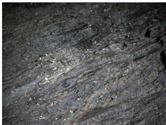
Sl. 3. Ksilit, binokular, uvećanje 6,5 x
