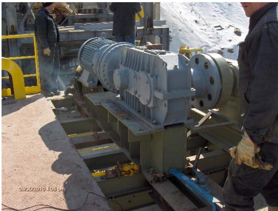
Sl. 4. Prikaz pogonske grupe. Elektromotor reduktor spojnica.
