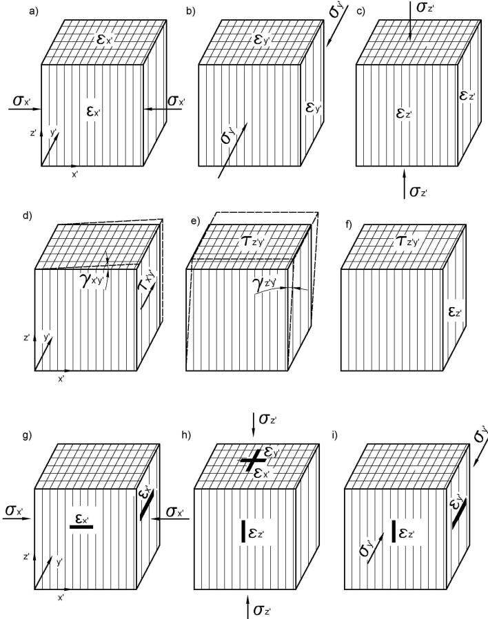
**Sl. 4.** Određivanje elastičnih konstanti stena za slučaj transverzalno izotropni model slojevite strukture
