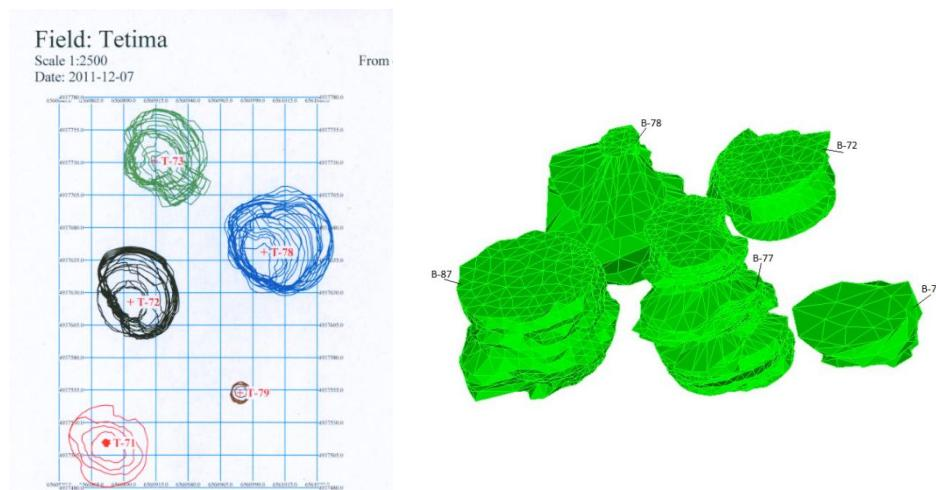
Sl. 1. Ultrazvučni snimak, presjek na odgovarajuće visini komore (a), 3D solid modeli (b)
