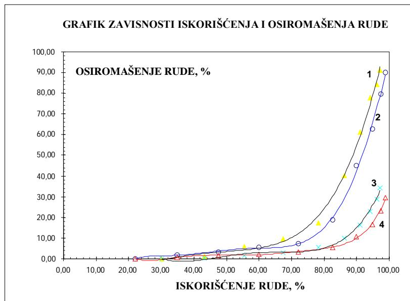
Sl. 4. Uporedni rezultati istakanja rude sa dve i tri utovarne komore za najbolje odnose parametara ( $H = 80 \text{ m}$ ,  $B = 12 \text{ m}$ ,  $l = 12 \text{ m}$ ).
