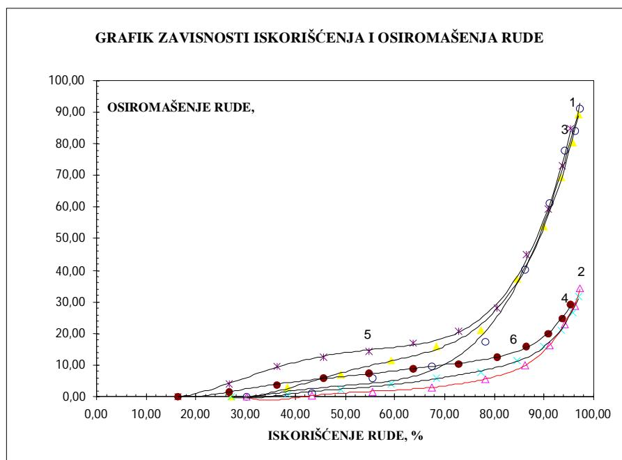
**Sl. 3.** Uporedni rezultati istakanja rude iz modela M-1 u II seriji (dve utovarne komore) za odnose parametara  $H = 80$  m,  $B = 12, 14$  i  $16$  m i  $l = 12$  m
