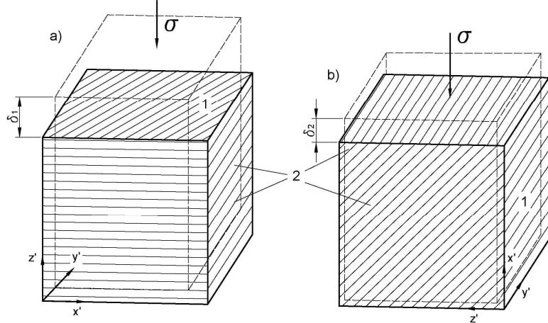
Sl. 3. Anizotropija deformabilnosti stena sa slojevitom struktururom
