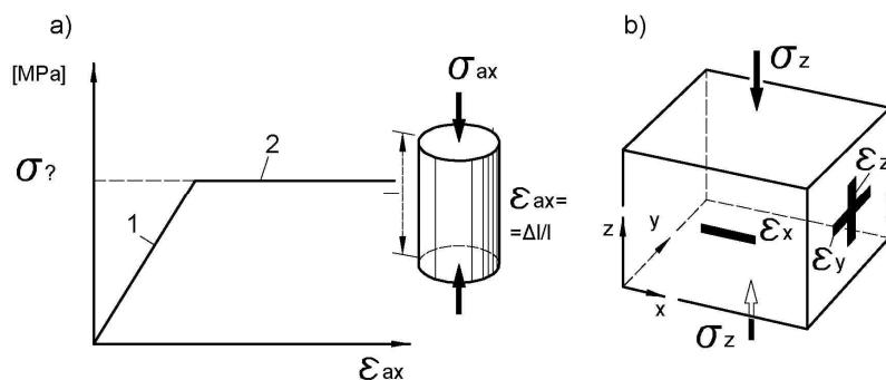
**Sl. 2. Deformabilnost izotropnih stena**
