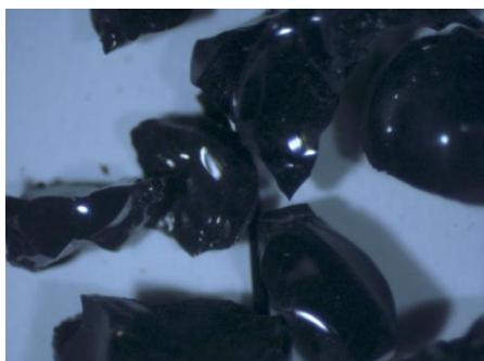
Sl. 2. Zrna granulisane šljake (oštih ivica), binokular, uvećanje 2,0 x
