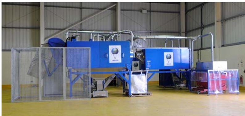
Slika 2. Postrojenje za reciklažu lampi
