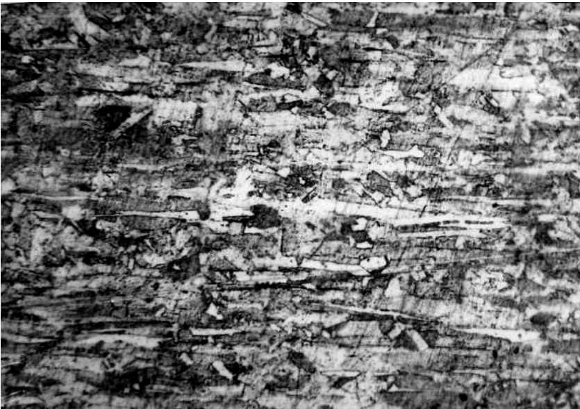
Slika 7. Mikrostruktura uzorka br. 2: 0,58% Sn 0,92% Te
