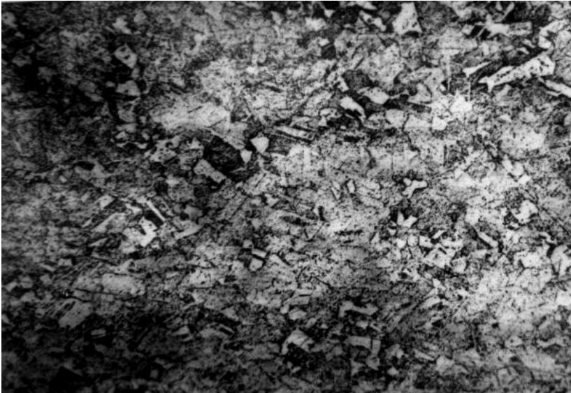
Slika 10: Mikrostruktura uzorka br. 5: 0,066% Sn
