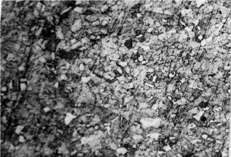
Slika 6. Mikrostruktura uzorka br. 1.: 0,058% Sn 0,092%Te
