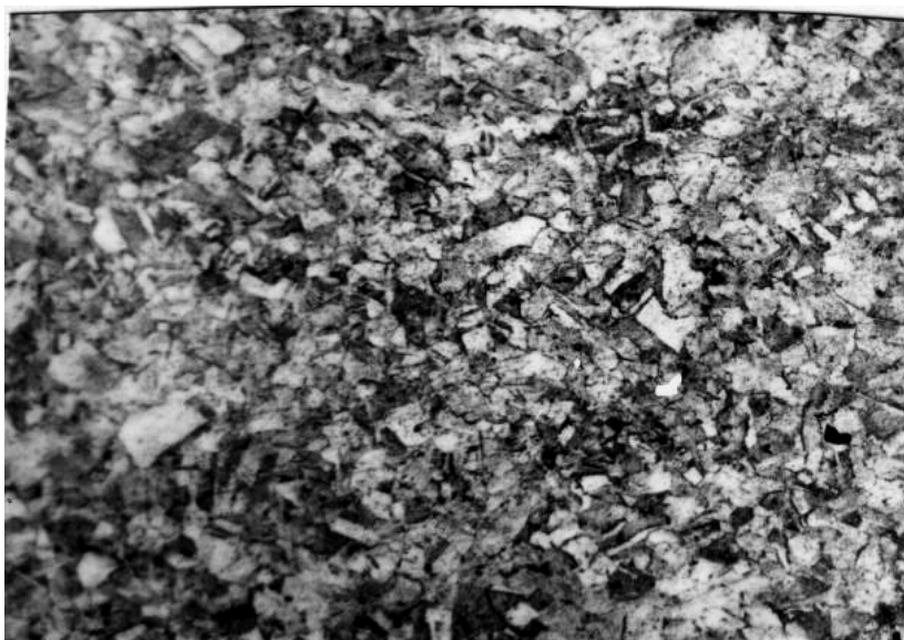
Slika 8. Mikrostruktura uzorka br. 3: 0,13% Sn 0,04% Te
