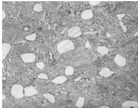
**Sl. 3.** Mikrostruktura legure CuAl10, zakaljena sa  $920^{\circ}\text{C}$  u vodi, uvećanje 100x
