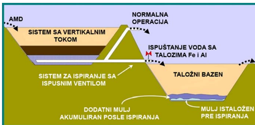
Sl. 5. Mokro polje sa vertikalnim podzemnim tokom i dodatom cevi za ispiranje sa ispusnim ventilom, što produžava radni vek ovog sistema, sprečavajući akumulaciju metalnih taloga u krečnjački sloj
