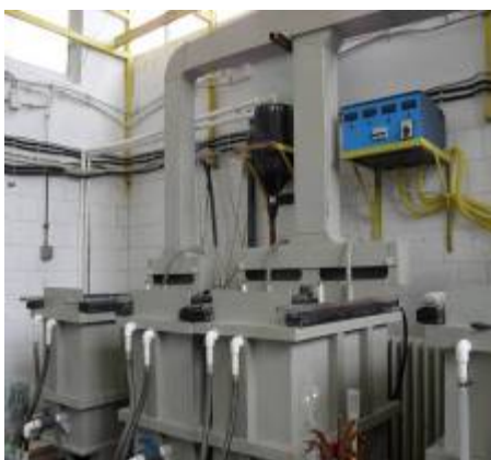
Sl. 2. Novo poluindustrijsko postrojenje za elektrolitičku preradu bakarnih anoda nestandardnog hemijskog sastava – Linija I
