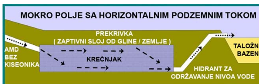
Sl. 3. Uprošćeni izgled mokrog polja sa horizontalnim podzemnim tokom (poprečni presek)
