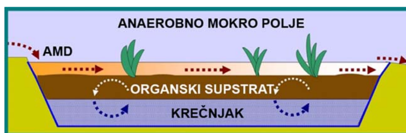
Sl. 2. Uprošćeni izgled anaerobnog mokrog polja (poprečni presek)
