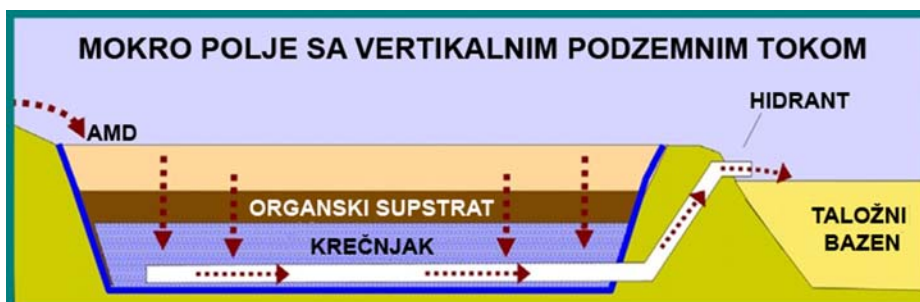
Sl. 4. Uprošćeni izgled mokrog polja sa vertikalnim podzemnim tokom (poprečni presek)
