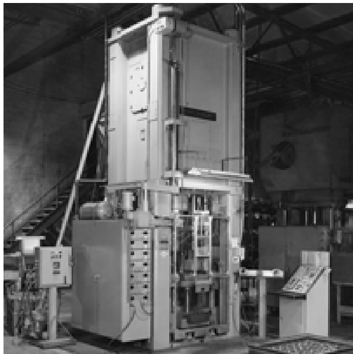
Sl. 5. Mehanička presa 7.3MN (825t) za presovanje metalnog praha u kompaktni oblik
