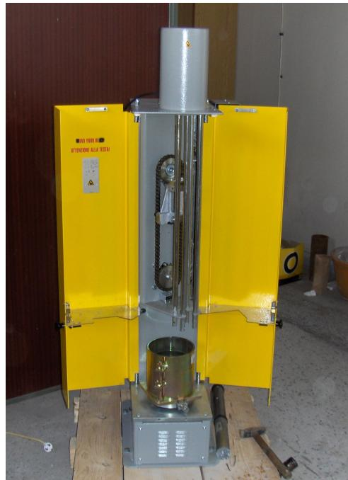
**Sl.1.** Proktorov aparat za određivanje optimalne količine vode pri maksimalnoj suvoj zapreminskoj masi
